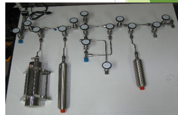
Próżniowy układ badania absorpcji wodoru - PAN
