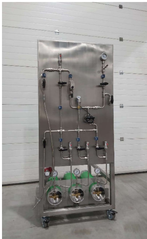
Stanowisko badawcze układu magazynowania wodoru – Instytut Fizyki Jądrowej
